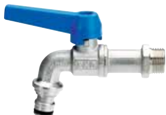
Rubinetto a sfera curvo, fil. maschio con leva, con attacco rapido, nichelato.
